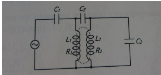
Energija iz primarnog kola se prenosi u sekundarno kolo putem induktivne sprege između kalemova  $L_1$  i  $L_2$ , i konenzatora za spregu  $C_s$ . Ova vrsta sprege se često sreće kod induktivno spregnutih kola, gdje se kapacitivna sprega ostvaruje preko parazitnih kapacitivnosti.
