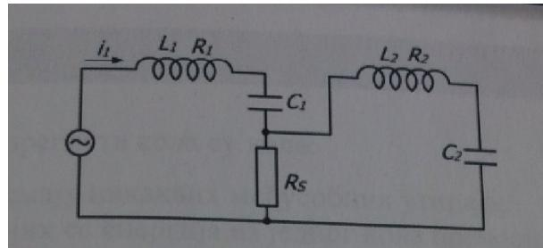
Preko galvanske sprege se može prenositi i jednosmjerna struja. Primarno kolo čine kalem  $L_1$ , kondenzator  $C_1$  i otpornik za spregu  $R_s$ . Sa otpornika  $R_s$  napon se odvodi u sekundarno kolo koga čine kalem  $L_2$  i kondenzator  $C_2$ . Ova sprega se rijetko koristi jer otpornik za spregu pogoršava karakteristike osculatornih kola.
