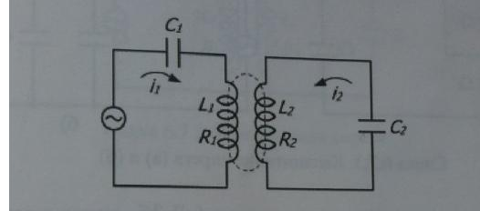
Primarno kolo je priključeno na generator i kroz njega protiče struja  $i_1$ . Ona stvara magnetno polje koje se zatvara preko drugog kalema (isprekidana linija). Ovo magnetno polje prati promjenu struje  $i_1$  (koja ga je stvorila). Zbog toga se u sekundarnom kolu indukuje ems usled koje teče struja  $i_2$ . Obje ove struje (energije) osciluju između kalema i kondenzatora u njihovom kolu.
