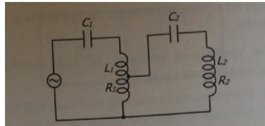
Primarno kolo sadrži kalem  $L_1$  i kondenzator  $C_1$  i priključeno je na generator naizmjenične struje. Sa dijela kalema  $L_1$  jedan dio napona se vodi na sekundarno kolo i na taj način se u sekundar prenosi energija.
